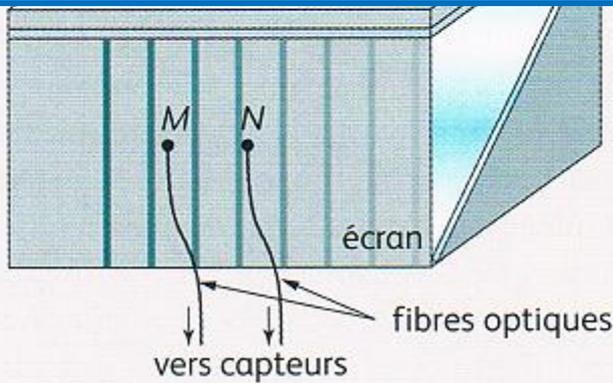
Les fibres optiques guident la lumière jusqu'à des capteurs photosensibles
