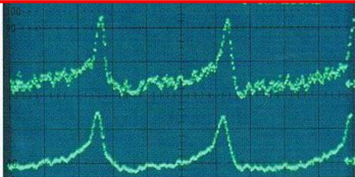
Une cuve à ondes est parcourue par une onde pratiquement sinusoïdale générée par la vibration d'une réglette. Les extrémités de deux fibres optiques sont placées contre l'écran de la cuve où la succession de zones sombres et claires permet l'étude de la propagation des ondes à la surface de l'eau. La lumière captée sur l'écran est transmise à des capteurs photosensibles qui délivrent des tensions proportionnelles à l'intensité lumineuse reçue.
