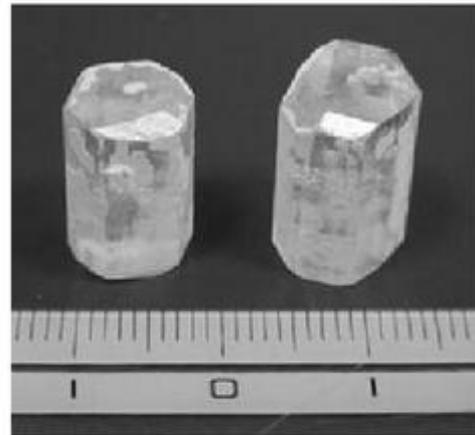
Cristaux de tartrate de sodium et ammonium préparés par Masao Nakazaki au Japon, en 1979 pour refaire les travaux de Pasteur
