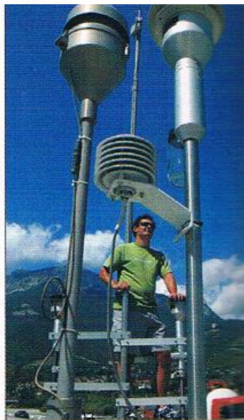
Prélèvements de polluants (dioxyde de soufre, particules en suspension, etc.) par une station mobile du réseau national ATMO.
